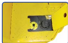
Легкий доступ к запору горловины топливного бака, находящемуся у ног оператора.
