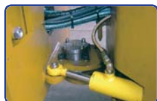
сочленение стержня со смазочными точками
