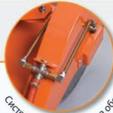
Контроль за глубиной реза посредством градуированного ручного механизма.
